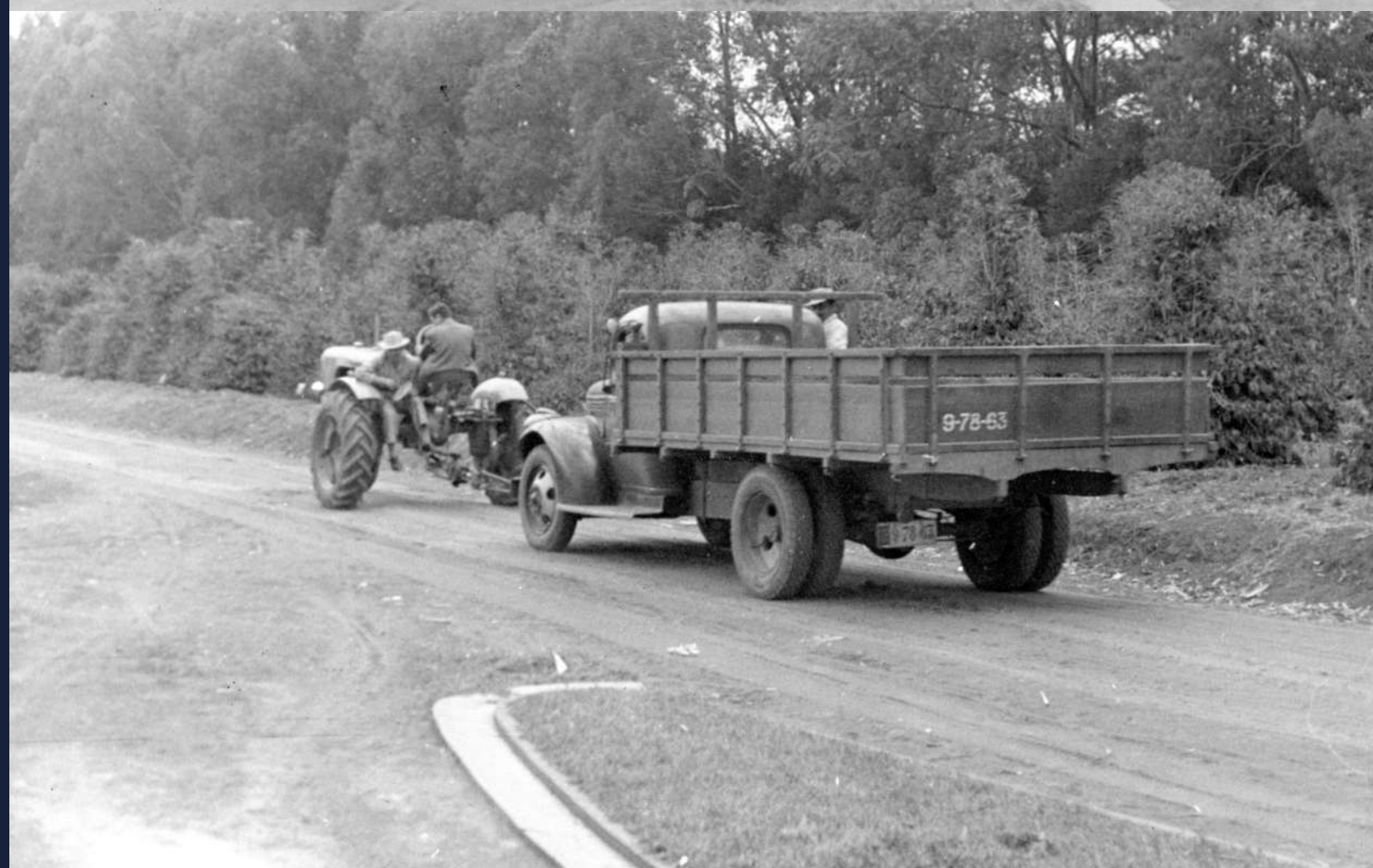
Trator Toro sendo submetido a testes de tração. Fotos: Autor desconhecido.
